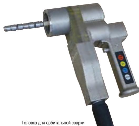
Головка для орбитальной сварки труб в трубную доску TX 38P: Идеально подходит для ремонта, обслуживания и обслуживания промышленных теплообменных систем.
